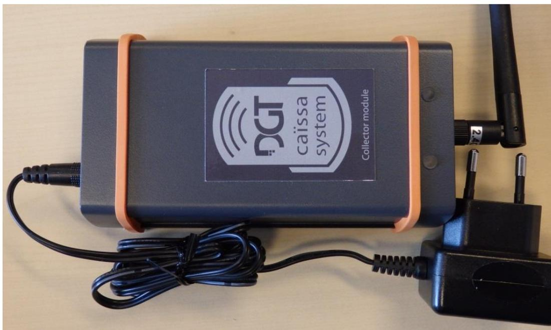
Conecte el Collector Module con el adaptador de alimentación de corriente.
