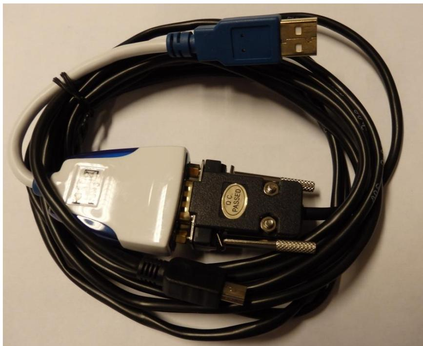
**Importante:** Por favor, asegúrese de que este cable sólo se utiliza para actualizar el BoMo. No utilice este cable entre el Collector Module y el ordenador, ya que se ha preparado para una transmisión en serie y puede causar daños a su Collector Module!!
